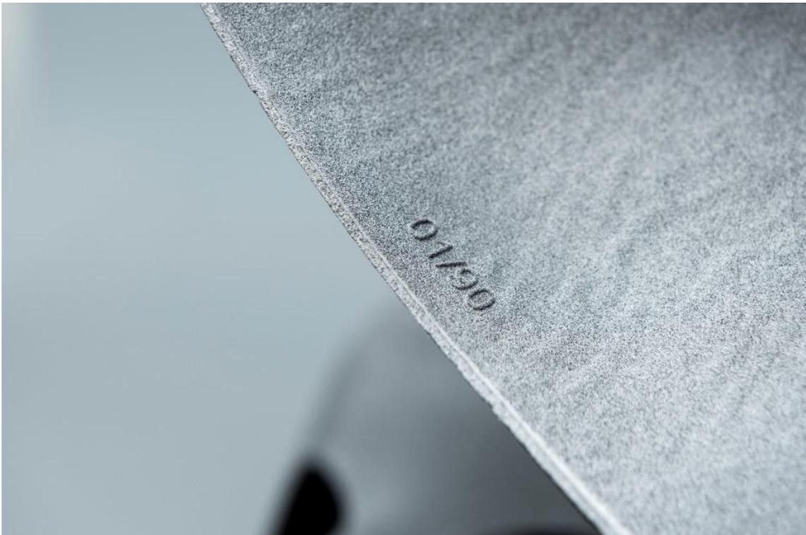
Durch die kurze Produktionszeit von vier Wochen und dem Kundenwunsch nach stabilen, aber zeitgleich detailreichen Bauteilen, wurde das MultiJet Fusion-Verfahren (MJF) des Herstellers Hewlett-Packard (HP) als Herstellungsmethode gewählt. Bei diesem Verfahren wird ein PA12 Pulver als Ausgangsmaterial verwendet, dieses wird mit Hilfe einer speziellen Tinte (Agent) in Form gebracht und mit Wärme und Licht ausgehärtet.
